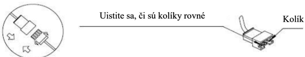
**POZOR:** Buďte opatrní při spojení dvou kabelu. Kolíky uvnitř konektoru musí být rovné, jinak to spôsobí problémy.
