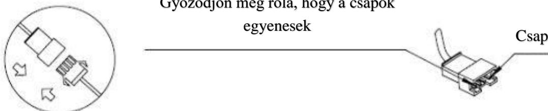
**FIGYELEM:** Legyen óvatos, amikor összeköti a két kábelt. A csapoknak a csatlakozó belsejében egyenesnek kell lenniük, különben problémát okoznak.
